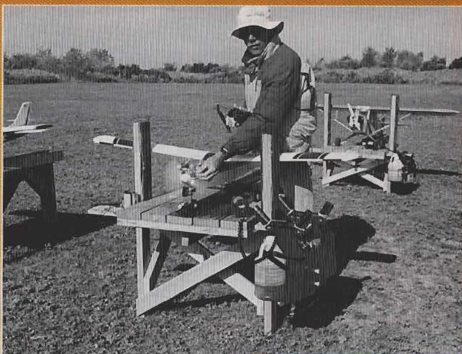
Fixer les rails latéraux (M) en 2,5 x 10 de chaque côté de la membrure centrale (G). Mettre de la moquette sur les parties hautes des montants verticaux avant (C) en la fixant avec des agrafes. La moquette doit protéger les ailes de l'avion lorsqu'il est sur le banc.
