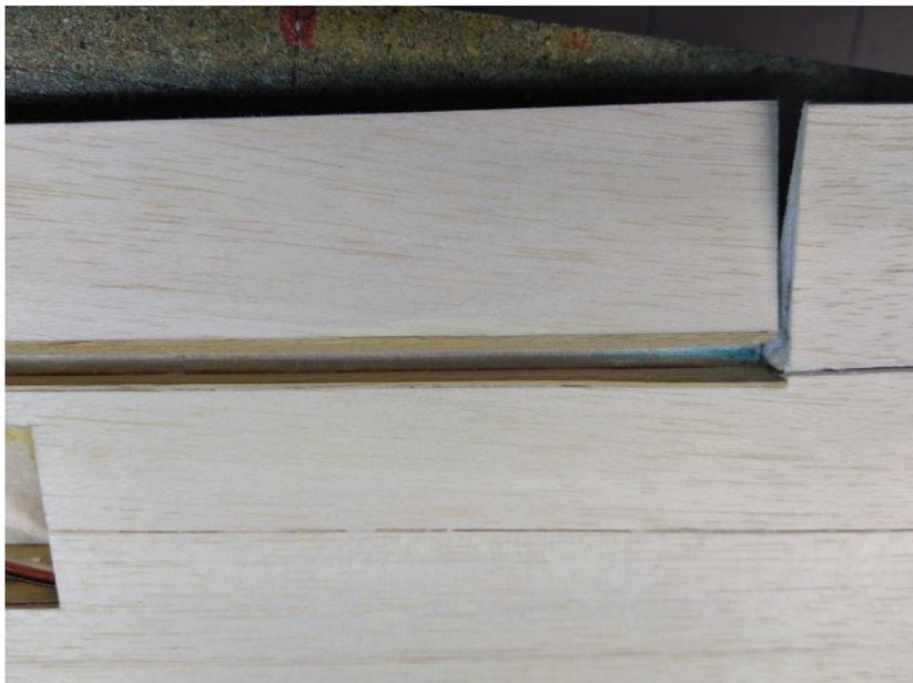
Coller des planchettes de samba sur les découpes longitudinale du volet et aileron afin de masquer le sipror. Laisser suffisamment de jeu pour l'entoilage et assurer le débattement nécessaire.
